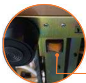
L'interrupteur est situé en bas à droite de la machine, à côté du pied avant.
